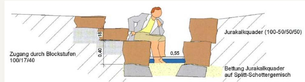
Abbildung 23: Querschnitt Ufergestaltung bei begrenzten Verhältnissen
